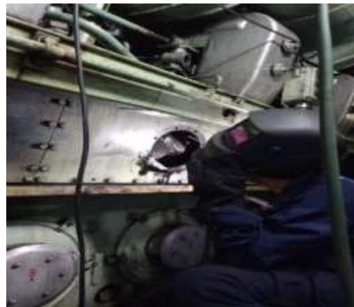
Gambar 3.3 Teknik Pengelasan Pada Camshaft Sumber : Dokumen Pribadi Penulis
