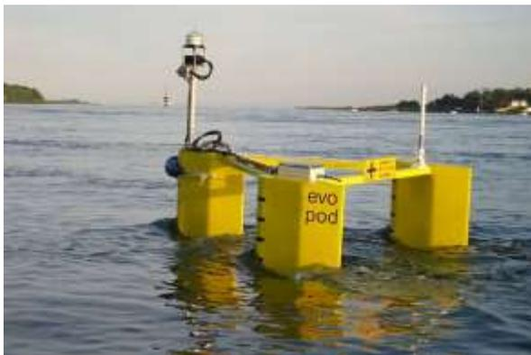
**Gambar 1.** Generator pembangkit listrik pasang surut air laut di Irlandia Utara (Ocean Flow Energy Ltd)
